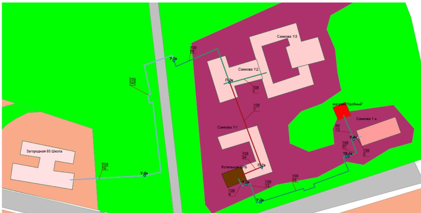
Рис. 6 Схема сетей отопления от котельной ЦРБ.
