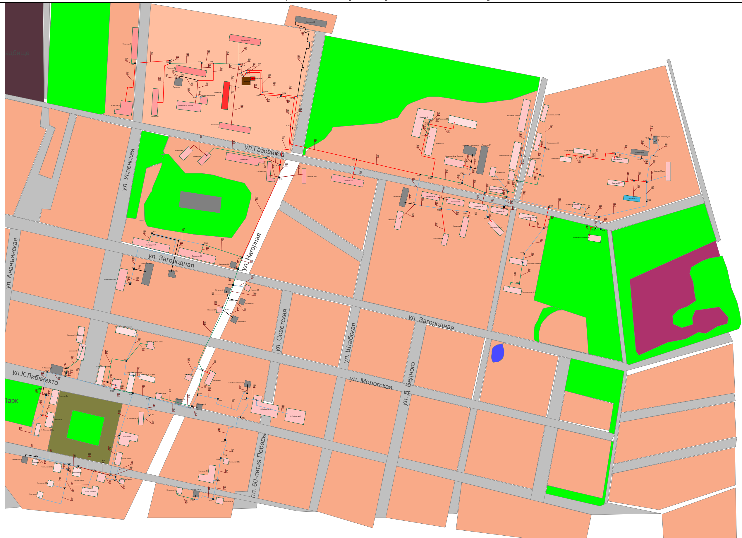
Рис.9. Центральная котельная - существующее положение системы теплоснабжения
