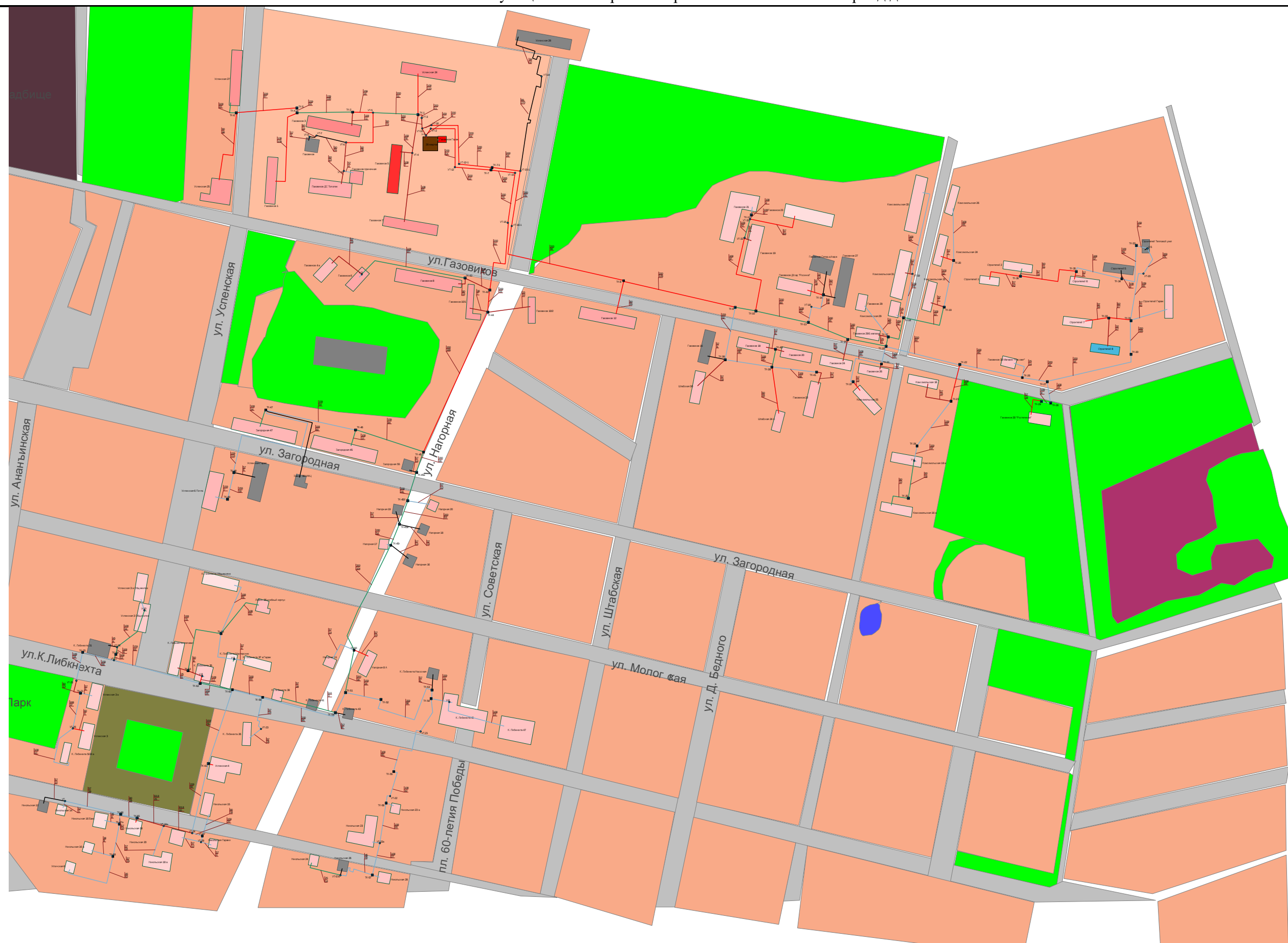
Рис.9. Котельная «26 квартал» - существующее положение системы теплоснабжения
