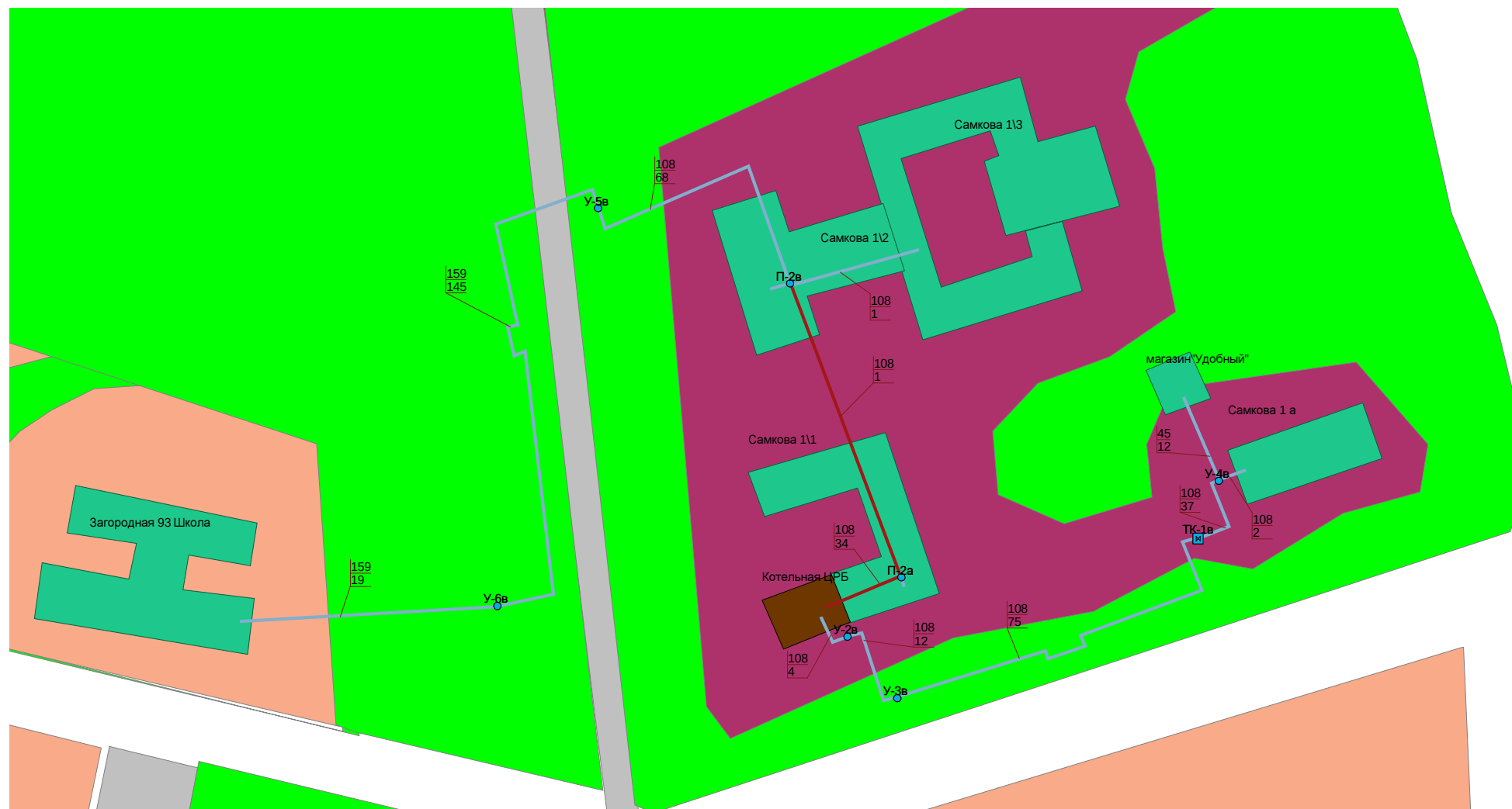
Рис. 11 Котельная ЦРБ - наладочный режим системы теплоснабжения (сети отопления)
