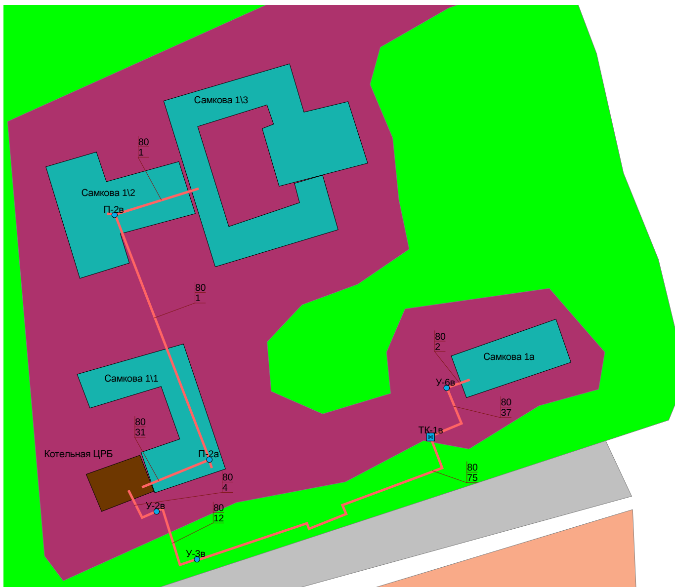
Рис. 10 Котельная ЦРБ - схема теплоснабжения (сети ГВС)
