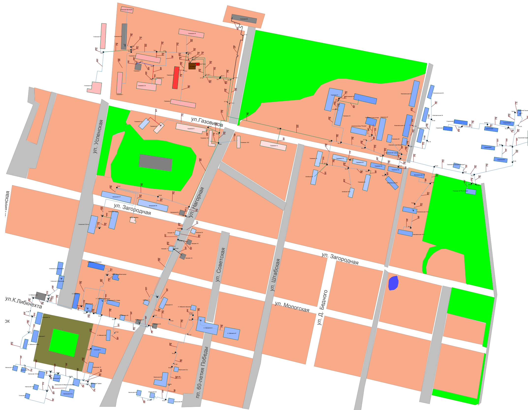
Рис.8 Котельная «26 квартал» - существующее положение системы теплоснабжения
