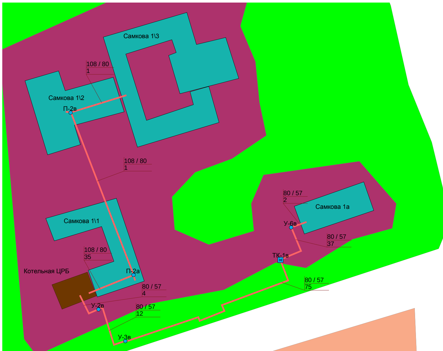
Рис. 12 Котельная ЦРБ - схема теплоснабжения (сети ГВС)
